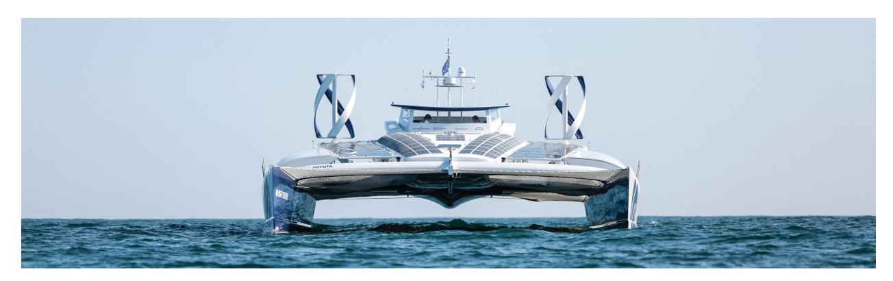
Développées avec l'ICAM de Nantes, elles ont été choisies pour l'absence de bruit, leur système antivibratoire et surtout la capacité à capter le flux quelle que soit sa direction. L'objectif était de miser sur la mixité énergétique et de bénéficier d'un appoint nocturne ou lorsque les conditions se dégradent.
