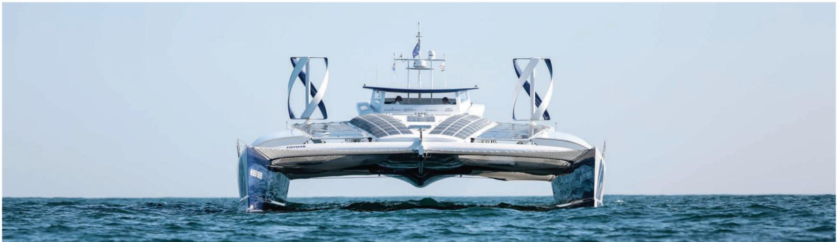
Développées avec l'ICAM de Nantes, elles ont été choisies pour l'absence de bruit, leur système antivibratoire et surtout la capacité à capter le flux quelle que soit sa direction. L'objectif était de miser sur la mixité énergétique et de bénéficier d'un appoint nocturne ou lorsque les conditions se dégradent.
