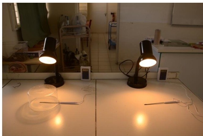
Doc 2: Evolution de la température dans un récipient en verre éclairé par une lampe en fonction du temps
