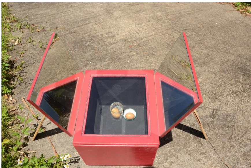
Doc 12 : photo du four solaire pendant le premier test de cuisson.
