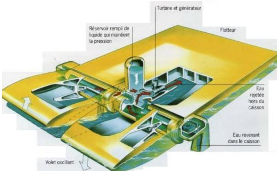
Une hydrolienne est une turbine hydraulique (sous-marine ou à flots) qui utilise l'énergie cinétique des courants marins ou fluviaux, comme une éolienne utilise l'énergie cinétique du
