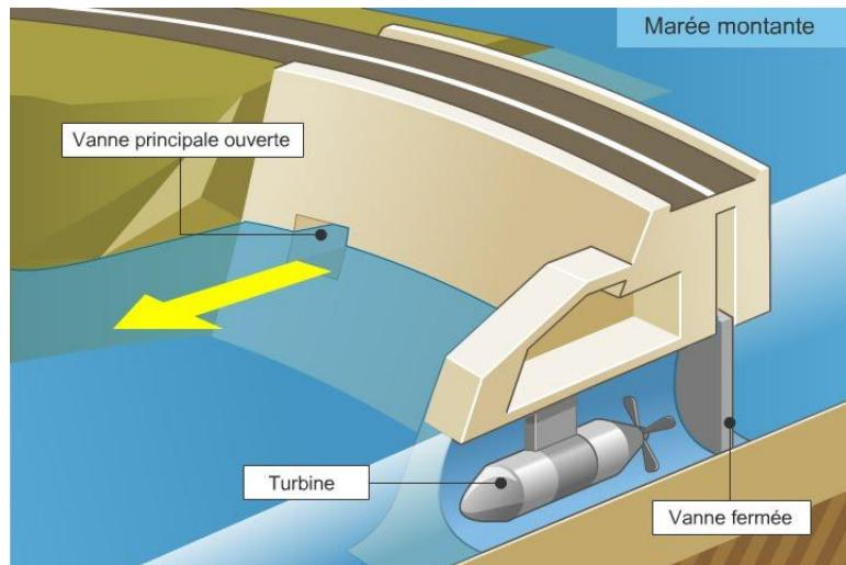
L'énergie marémotrice est issue des mouvements de l'eau créés par les marées et causés par l'effet conjugué des forces de gravitation de la Lune et du Soleil. Elle est utilisée sous forme d'énergie potentielle — grâce à l'élévation du niveau de la mer — ou sous forme d'énergie cinétique — grâce aux courants des marées.
