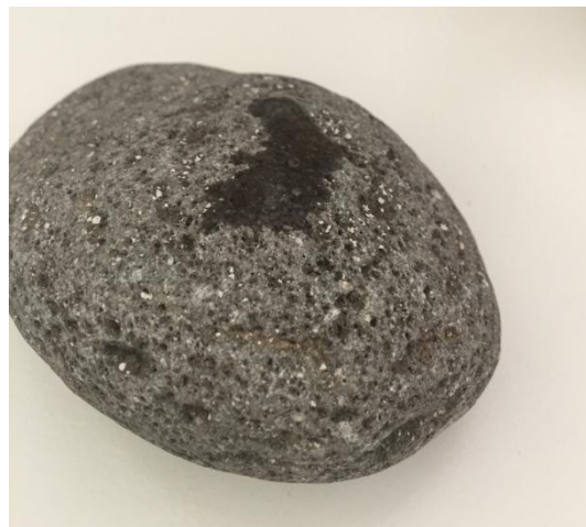
Test à l'acide sur un échantillon récolté sur place : pas d'effervescence
