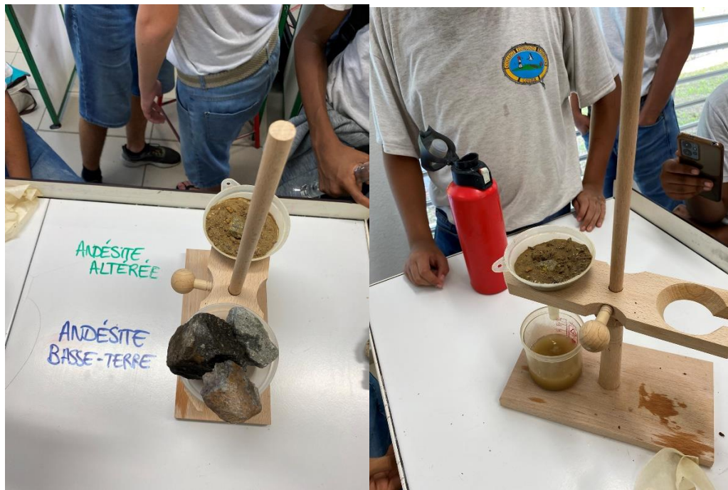
Test de perméabilité sur les blocs d'andésite et les dépôts andésitiques
