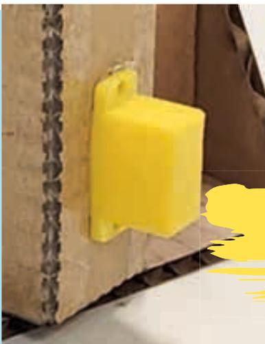
*La création de servo-moteurs factices embellit les maquettes de supports de caméra, facilite l'évaluation des concepts et permet de maîtriser les coûts.*
