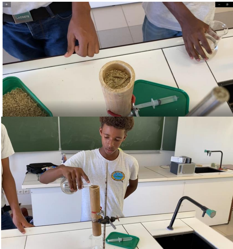
Filtration de l'eau dans un bambou percé, rempli de copeau de bambou
