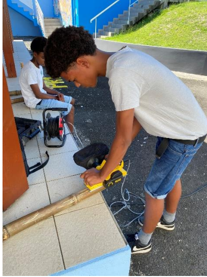
Récupération de fibres de bambou avec un rabot
